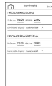
E' possibile definire due fasce orarie (diurna e notturna) e assegnare al display e al led un livello di intensità luminosa diverso per ognuna di esse. Sono disponibili 5 livelli di luminosità, più un livello 0 che corrisponde a display spento (il led invece si accende con intensità minima, ovvero livello 1, perchè non può mai essere completamente spento).
